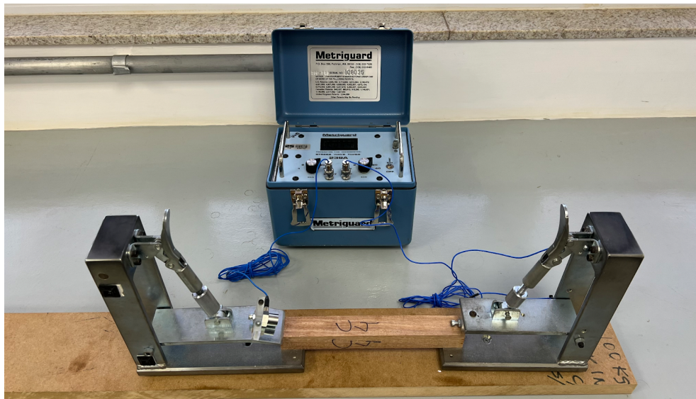
Figura 11 - Stress Wave Timer , modelo 239A da Metriguard, apresentando o polo emissor e o receptor
