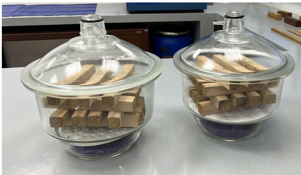
Figura 13 - Dessecadores com gel de sílica utilizados para aclimatizar as amostras das madeiras estudadas.
