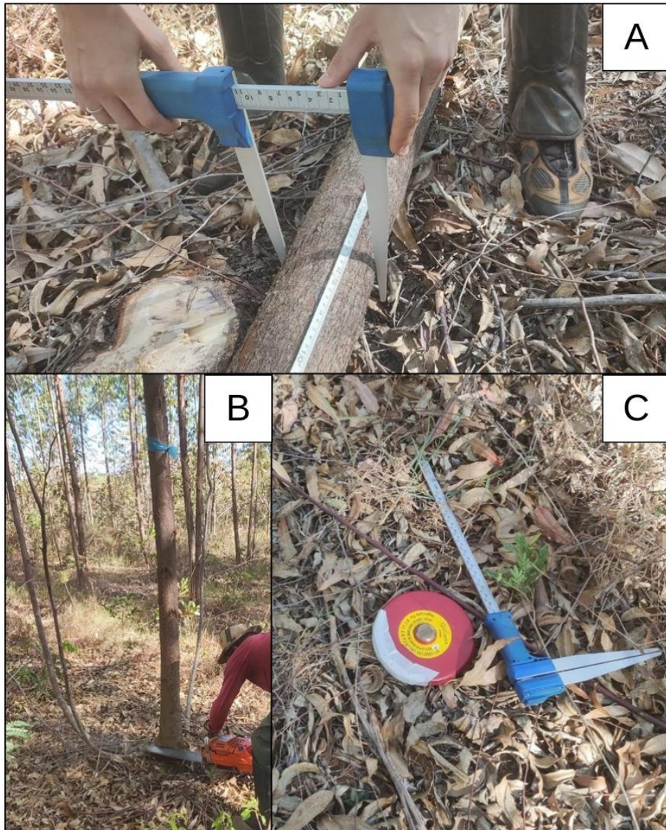
Figura 3. A) Medição de Di com sulta e trena esticada para delimitar HT; B) Corte de fuste com moto serra; C) Sulta e Trena Utilizados em campo.
