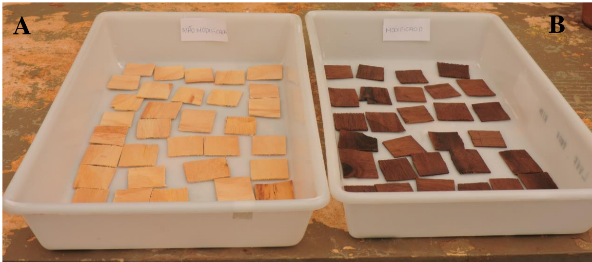
Figura 4 - Corpos de prova: testemunhas (A) e modificados termicamente (B) redimensionados. Fonte: Autor.
