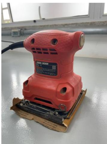
Figura 11 - Lixadeira manual utilizada para o lixamento das madeiras.
