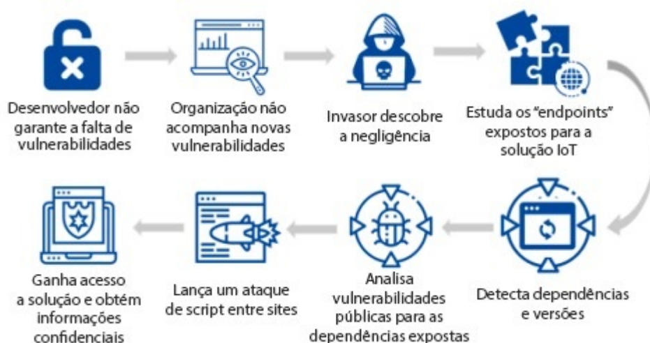
Figura 12 – Fluxo de Ataque - Dependências de Software Inseguras
