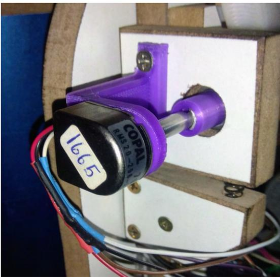
(a) Encoder acoplado ao suporte
