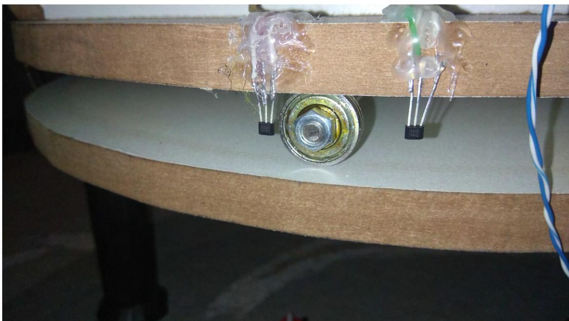
Dois sensores *hall* são posicionados no disco de superior, chamaremos o primeiro de sensor A e o segundo de sensor B, também um sensor *hall* posicionado na haste que segura o eixo de atitude do telescópio, que chamaremos de sensor C. Todos os sensores têm o critério de parada quando é percebido um campo magnético.
