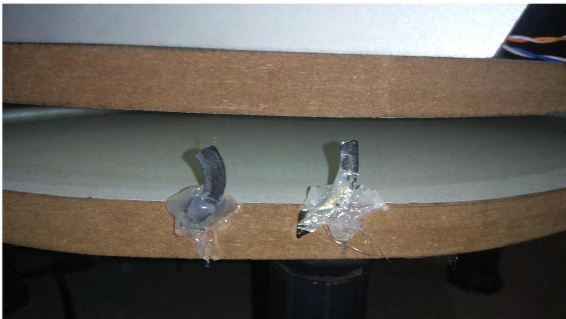
Figura 41 – Sensor Hall A e Sensor Hall B (Fonte: De autoria própria.)
