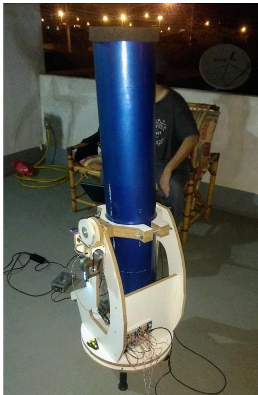
Nessa bancada de testes, verificamos o tempo de deslocamento do telescópio, a diferença da distância real para a distância desejada e o tempo de rastreamento até o objeto sair da focal.
