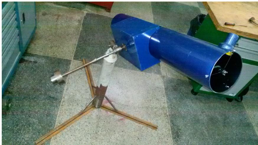
A base equatorial atual foi construída com caráter provisório, pois é muito pesada, com cerca de 30 kg, e é de difícil operação, pois necessita da utilização de ferramentas(chave de fenda, alicate) para destravar seus eixos e não possui nenhum mecanismo para auxiliar o observador sobre sua orientação espacial.
