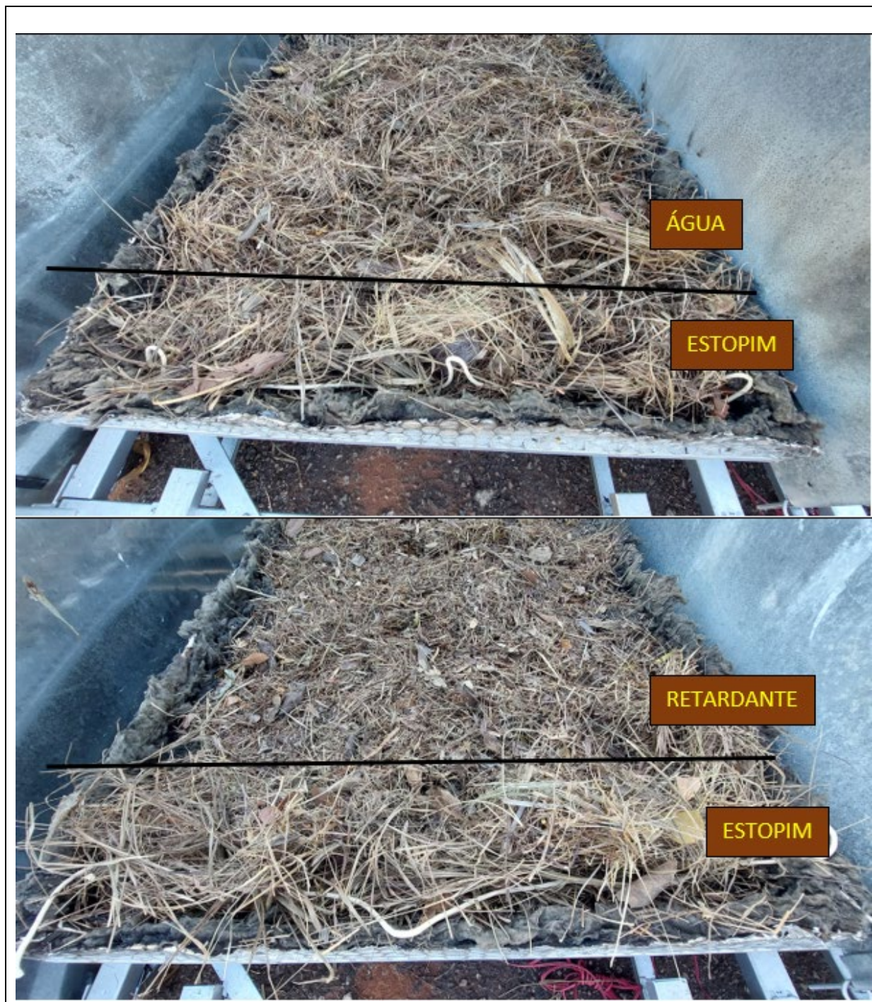
Figura 9. Bandeja com retardante (de baixo) e com água (de cima), ambos com aproximadamente 20 cm de largura. Os estopins não receberam água nem solução com retardante, o cordão embebido em álcool e gasolina ficou com três pontas para fora de modo a receber facilmente o calor da tocha acesa e iniciar a queima ao mesmo tempo com a mesma intensidade para os dois tratamentos.
