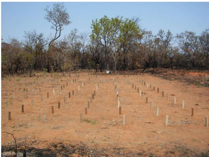
Figura 4. Campo de apodrecimento instalado na Fazenda Água Limpa (FAL/UnB). Fonte: Teles (2014).
