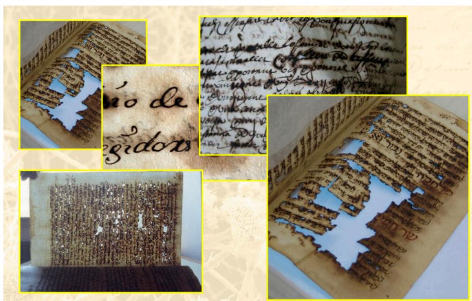
Figura 9. Alguns documentos antigos escritos com tintas metalogálicas e os efeitos de sua corrosão.
