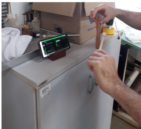
Figura 11. Teste de afinação das teclas de xilofone com auxílio do aplicativo DaTuner. Detalhe da pegada em forma de pinça nos pontos nodais da tecla. Fonte: Autor.
