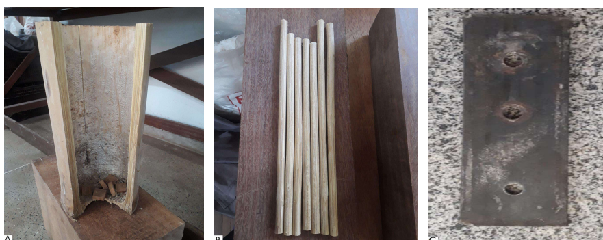
Figura 12. Desdobro de Dendrocalamus asper , para confecção das peças roliças utilizadas na ligação entre as barras de Araucaria angustifolia . A) D. asper parcialmente recortado; B) Transformação das tiras de D. asper em peças roliças; C) Gabarito pelo qual ocorreu o ajuste de espessura das peças roliças. Fonte: Autor.
