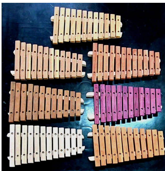
Figura 17. Xilofones padrão educacional confeccionados a partir do desdobro de madeira de sete espécies da Amazônia brasileira. Fonte: Autor.
