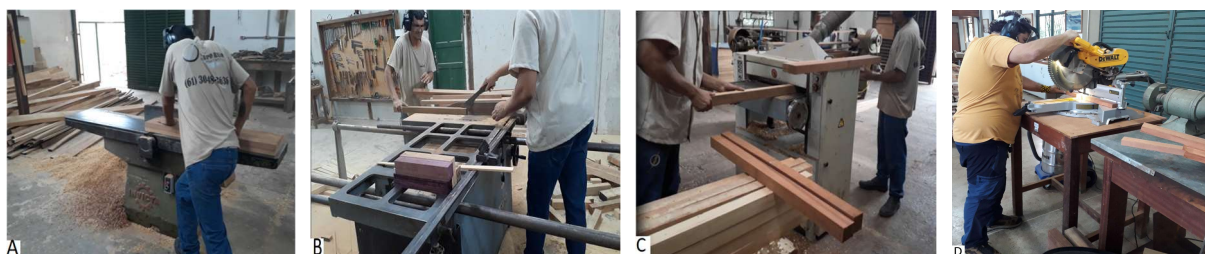
Figura 3. Máquinas utilizadas para a confecção dos corpos de prova de sete espécies de madeira da Amazônia brasileira. A) Plaina desempenadeira; B) Serra circular esquadrejadeira; C) Plaina desengrosso; D) Serra meia esquadria. Fonte: Autor.
