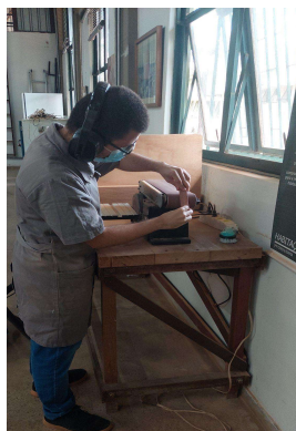
Figura 9. Processo de desbaste das teclas por meio da lixadeira de cinta, para alcançar a afinação desejada. Fonte: Autor.
