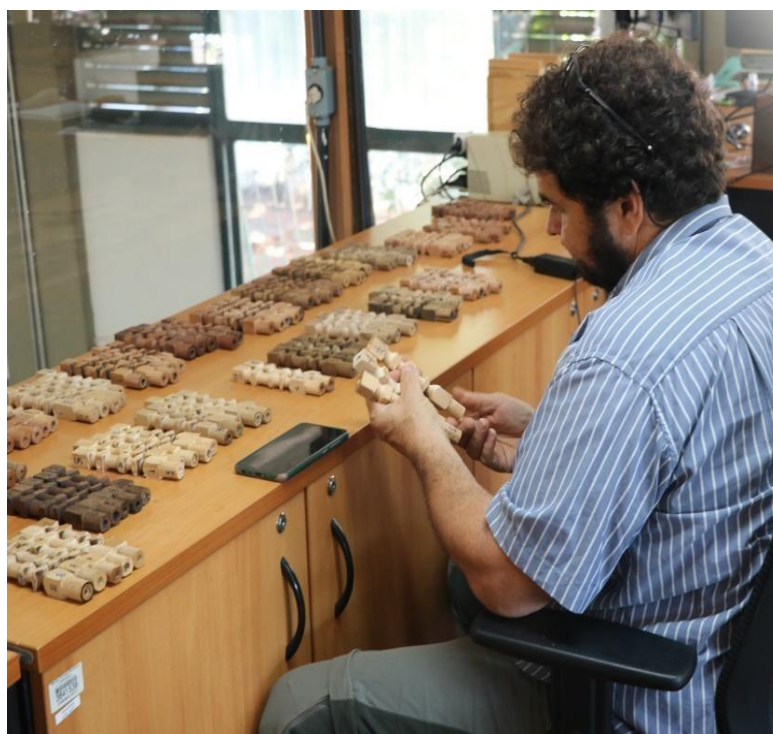
Figura 11. Análise visual e classificação da qualidade dos corpos de prova ensaiados realizada por um dos avaliadores.
