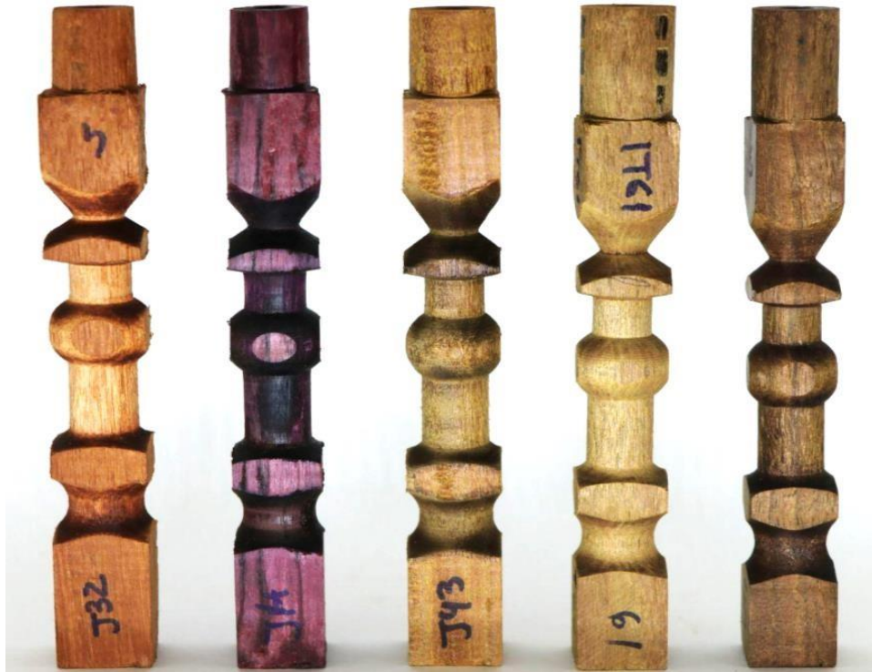
Figura 12. Espécies que obtiveram as notas 1 e 2 na avaliação do acabamento, seguindo a ordem da esquerda para a direita, temos: Martiodendron elatum , Peltogyne lecointei , Handroanthus incanus , Terminalia amazonia e Chamaecrista scleroxylon .
