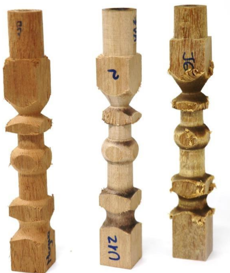
Figura 6. Exemplos de tipos de defeitos normalmente observados após torneamento da madeira, onde se destaca a aspereza que é representada pela Khaya grandifoliola (1° CP), arrancamento de grã observada em Protium sagotianum (2° CP) e arrepiamento das fibras em Dipteryx odorata (3° CP).
