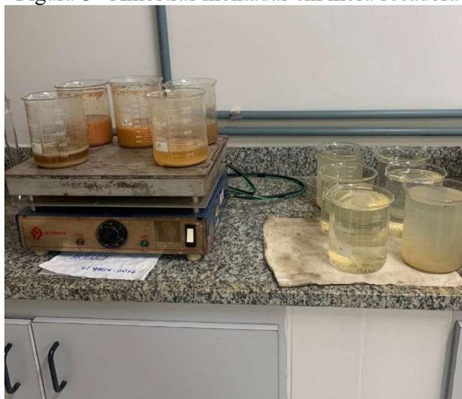
Figura 9 - Amostras de solo após o processo de evaporação da água
