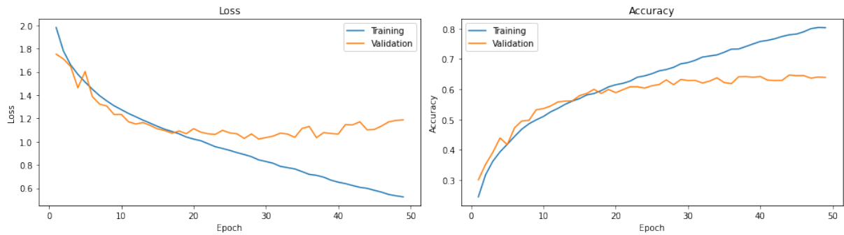
Figura 38 – Gráfico de acurácia e perda da CNN com 4 camadas - 3ª rodada
