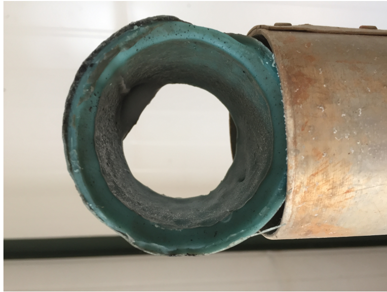
Figura 35: Grão após o ensaio
