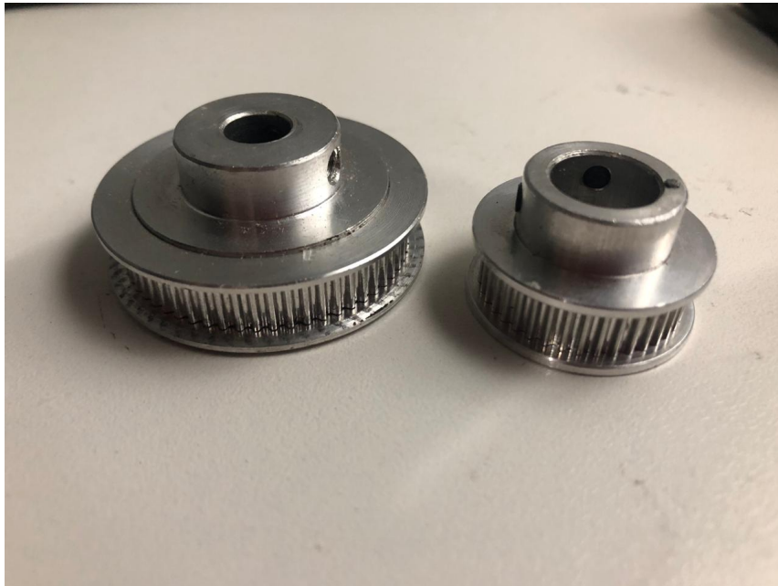
Figura 23: Polias utilizadas para transmissão de potência do motor elétrico para o eixo de acionamento da bancada de fabricação de grãos
