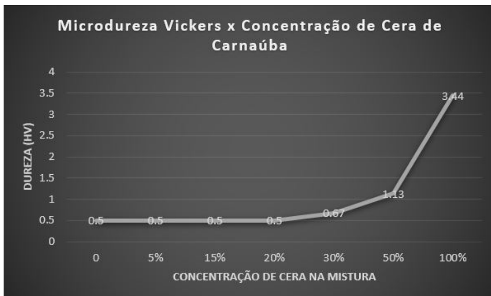
Figura 52: Curva Microdureza Vickers VS Concentração de Cera de Carnaúba
