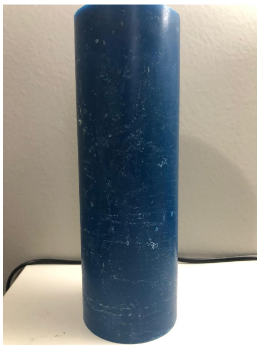
Figura 46: Grão fabricado utilizando Método de Fabricação Proposto
