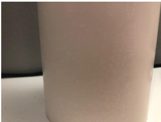
Figura 41: Bolhas de ar no grão produzido pelo Método de Fabricação 1
