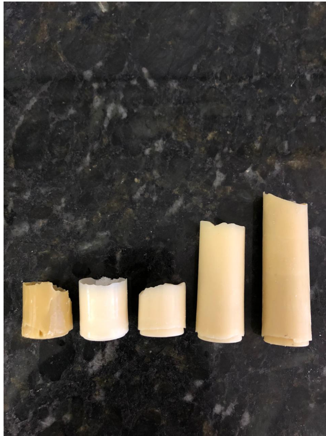
Figura 33: Corpos de prova utilizados na primeira rodada de ensaios de microdureza Vickers
