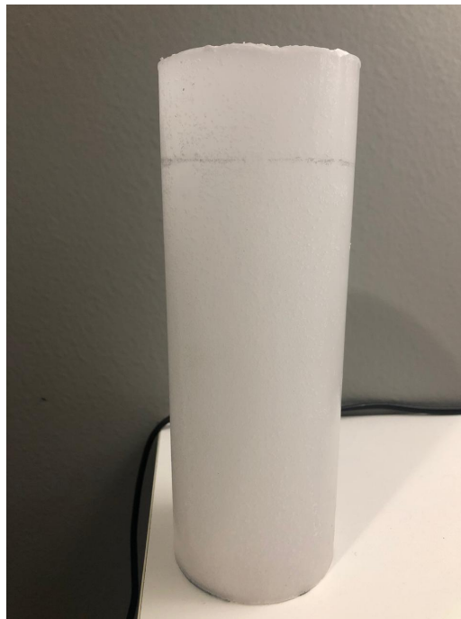
Figura 42: Grão de parafina produzido pelo Método de Fabricação 2
