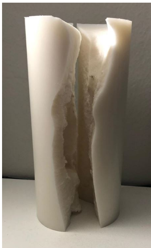
Figura 40: Grão produzido pelo Método de Fabricação 1 após tentativa de furo com broca
