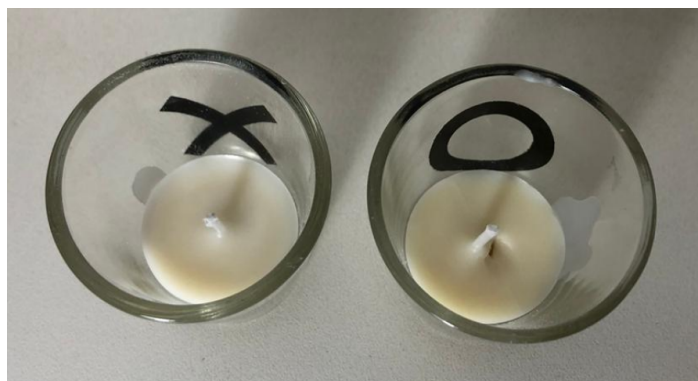
Figura 26: Exemplos de corpos de prova utilizados para estudo de taxa de regressão
