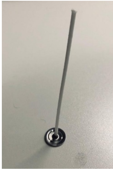
Figura 25: Pavio utilizado para ensaios de análise de taxa de regressão
