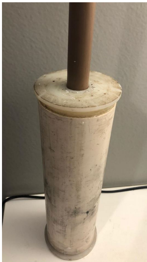
Figura 44: Tubo de PVC e tubo interno para criação do furo passante do Método de Fabricação 2
