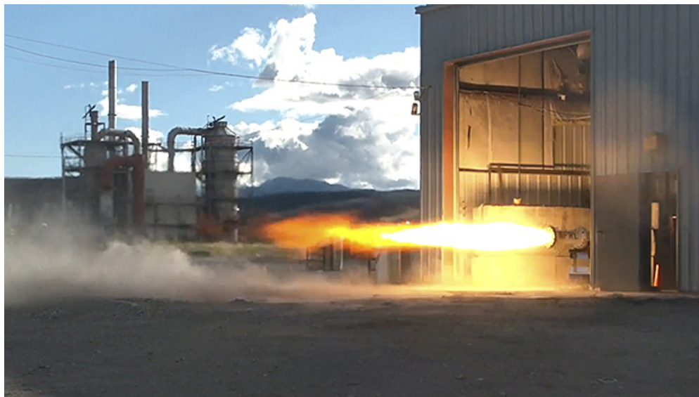
Figura 6: Teste de Motor com Propelente Híbrido [Jose Stevens/SPG]
