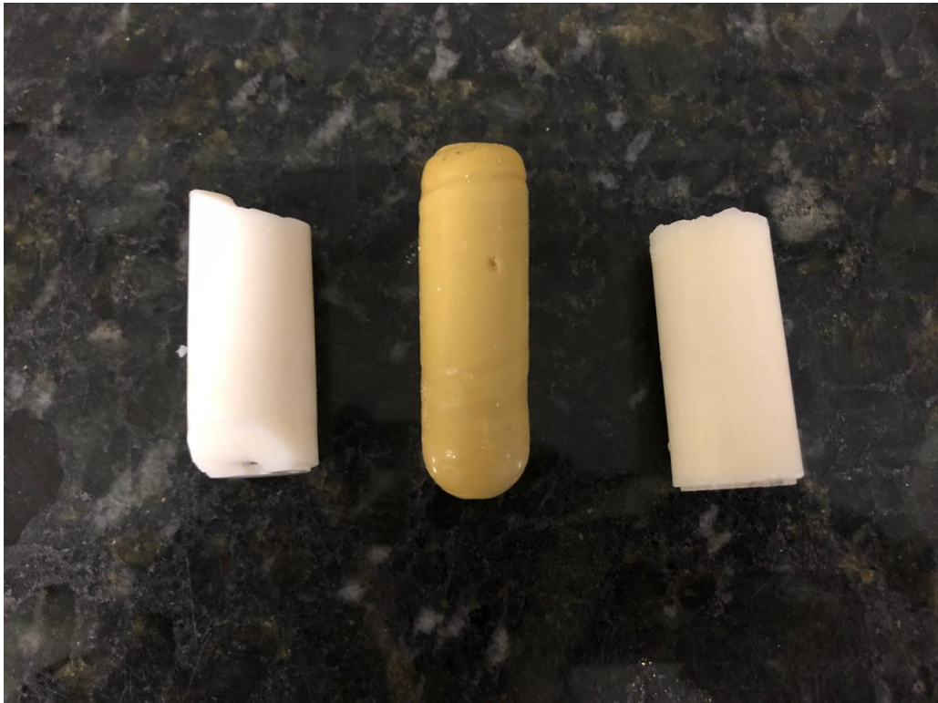
Figura 32: Corpos de prova utilizados na primeira rodada de ensaios de microdureza Vickers
