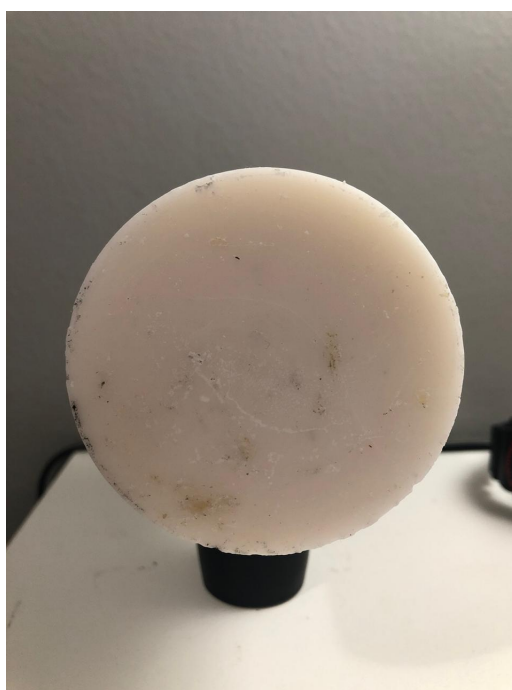
Figura 38: Grão de parafina produzido pelo Método de Fabricação 1
