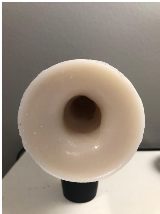
Figura 39: Grão de parafina produzido pelo Método de Fabricação 1
