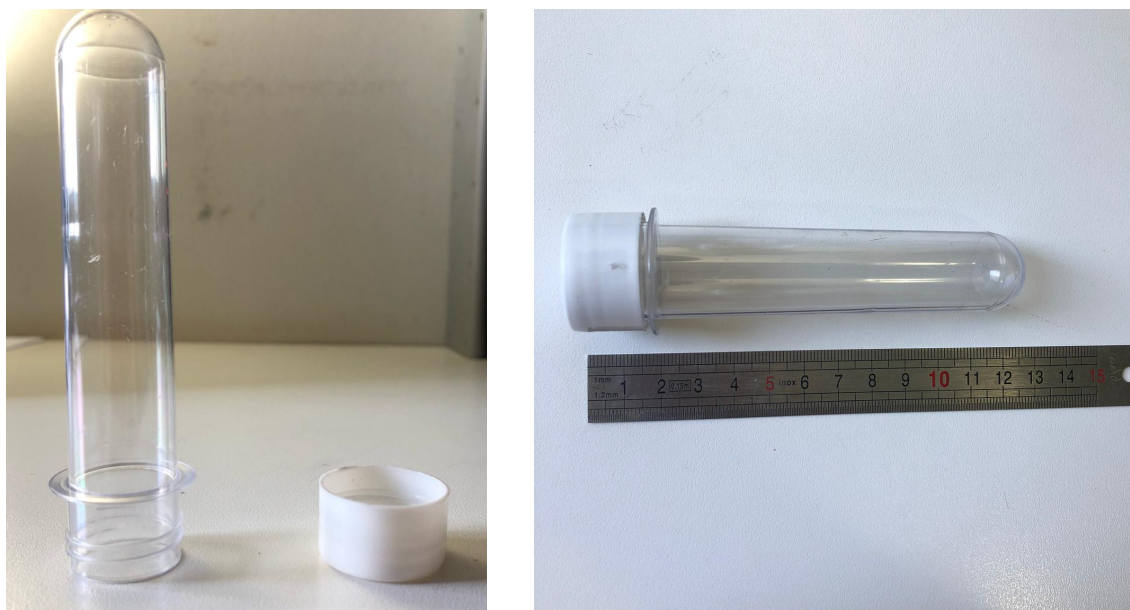
Figura 24: Pequeno tubo de plástico utilizado para a fabricação de corpos de prova
