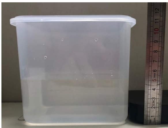
Figura 30: Configuração utilizada para a definição do volume das seções transversais de grãos
