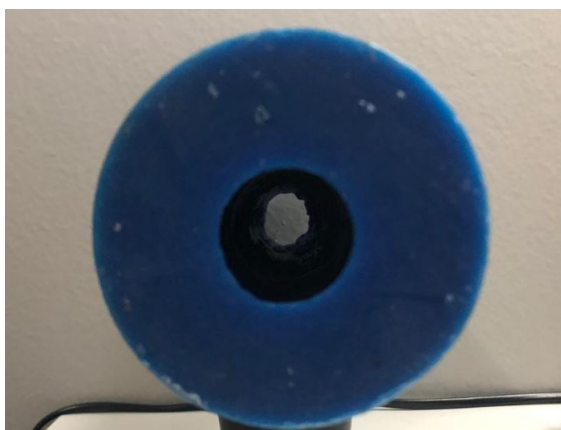
Figura 47: Grão fabricado utilizando Método de Fabricação Proposto
