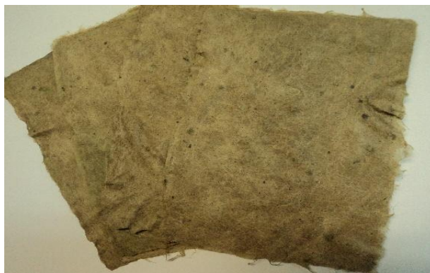
Foto 63: Papel finalizado ensaio 1 (proporção 80% bananeira 20% pequi) / Laboratório de Papel Artesanal. (IDA). UnB, 2017.
