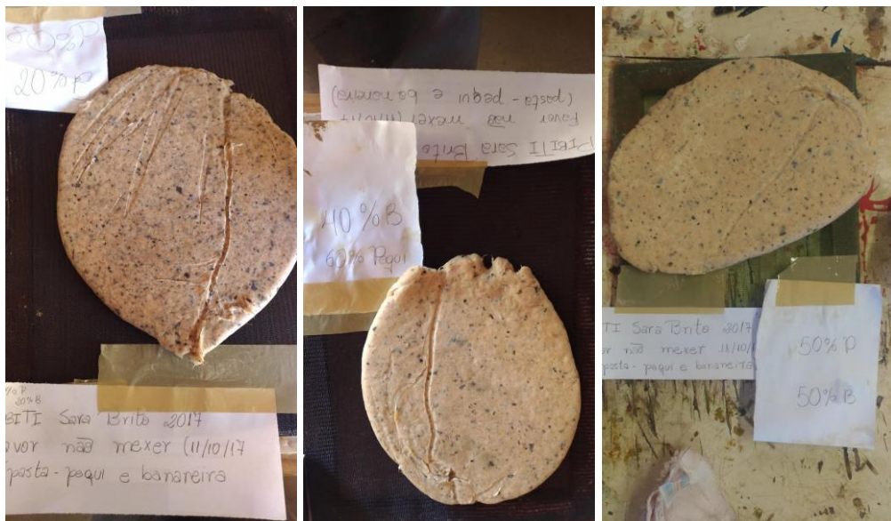
Foto 76, 77 e 78 – Pastas descoloridas com água sanitária e prensadas (1A- 50% e 50%B; 2B- 60%P e 40%B; 3C- 80%P e 20%B) / Laboratório de Papel Artesanal. (IDA). UnB, 2017.
