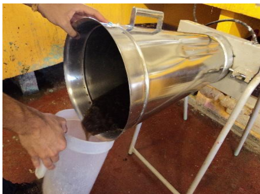
Foto 12: Utilizando liquidificador industrial para bater a pasta de bananeira e cascas de pequi/ Laboratório de Papel Artesanal. (IDA). UnB, 2017.
