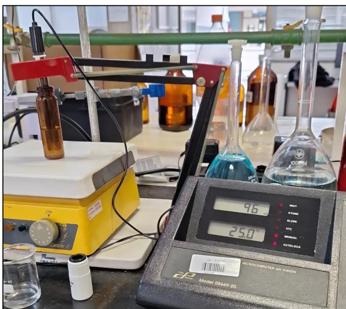
Figura 10 – Procedimento realizado na titulação potenciométrica do ibuprofeno em laboratório. Fonte: própria.
