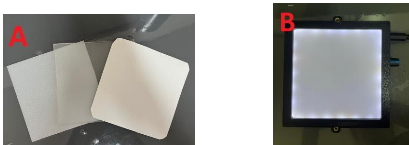
Figura 9 – Placas plásticas utilizadas na base da cabine (A) Placas plásticas (B) Base da cabine montada. Fonte: Acervo pessoal.
