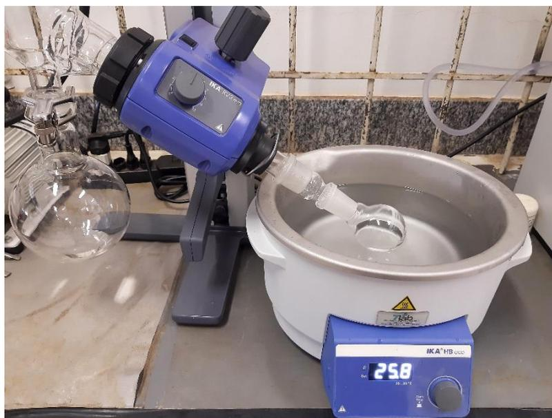
**Figura 18.** Balão volumétrico contendo extrato etanólico do cerne de *Peltogyne lecointei* após rotaevaporação do solvente.
