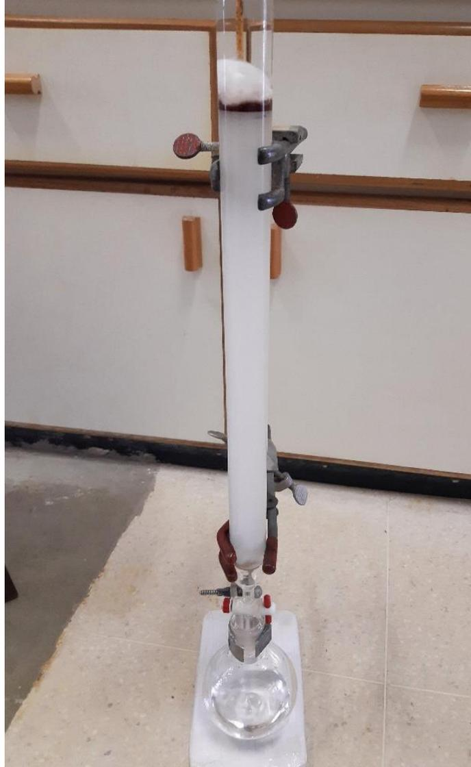
**Figura 21.** Cromatografia em coluna para o extrato obtido em acetato de etila com etanol. Pode-se observar cores diferentes, variando do amarelo para o verde conforme o decorrer da separação. As colunas subsequentes apresentaram colorações semelhantes.
