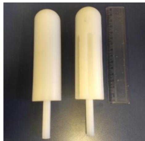
Figura 8: Molde em poliacetal. Fonte: [Faria 2018]
