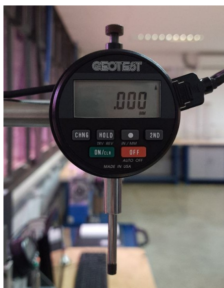
Figura 15 – Sensor de deslocamento
