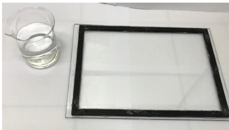
Figura 10 - Foto que ilustra a placa de vidro com bordas feitas em impressora 3D empregada para a produção dos filmes pelo método casting. Fonte: autoria própria (2023).
