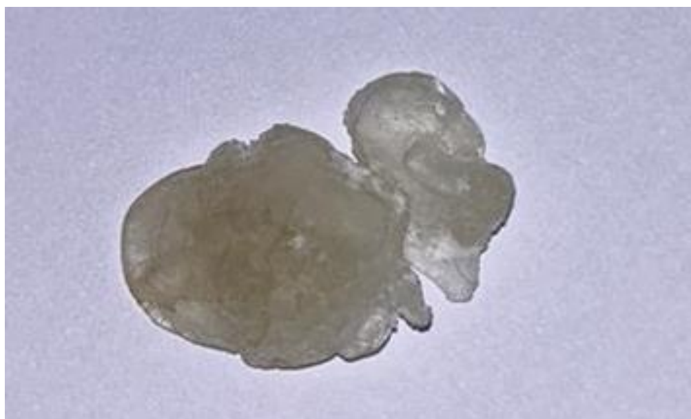
Figura 49. Produto da polimerização sem solução a partir do monômero do óleo de macaúba.
