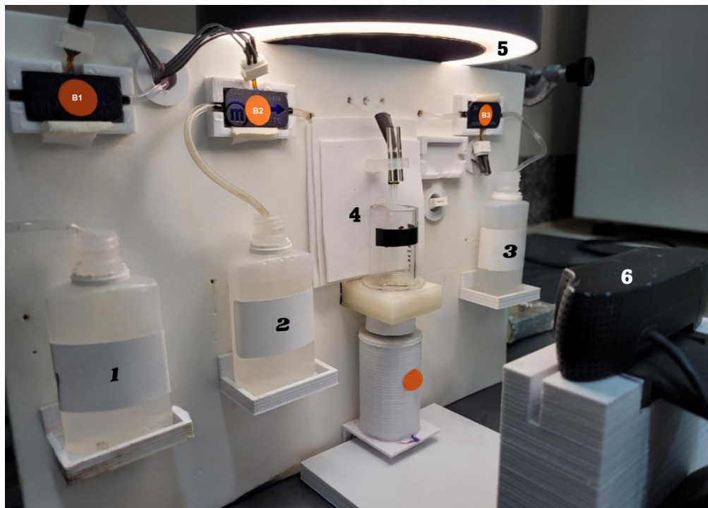
Figura 10. Primeira versão do sistema FB proposto. Em B1, B2 e B3 as mini-bombas piezoelétricas, em 1, 2 e 3 os reagentes, em 4 o reator e a agitação magnética, em 5 o ring light e em 6 a webcam.
