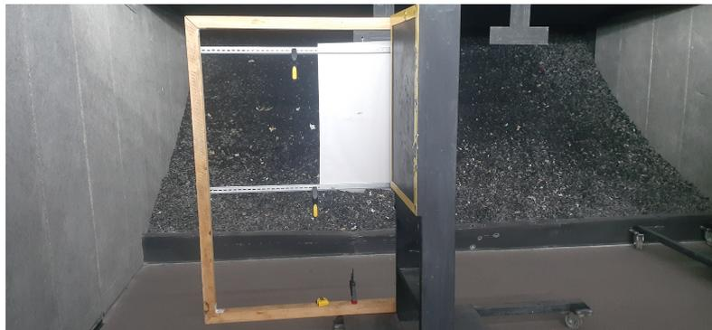
Visão em perfil do coletor de estilhaços fabricado manualmente. Fonte: acervo próprio. À direita e perpendicularmente à moldura, o suporte onde é fixado o alvo; entre os trilhos horizontais, é fixado o papel-testemunha responsável por coletar as marcas de estilhaços.
