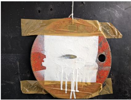
(a) Marca deixada por projétil a  $10^\circ$  de incidência
