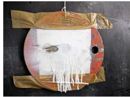
(b) Marca deixada por projétil a  $30^\circ$  de incidência
