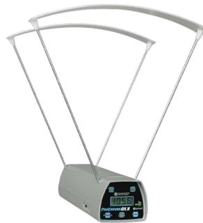
Cronógrafo Prochron DLX utilizado no experimento.
