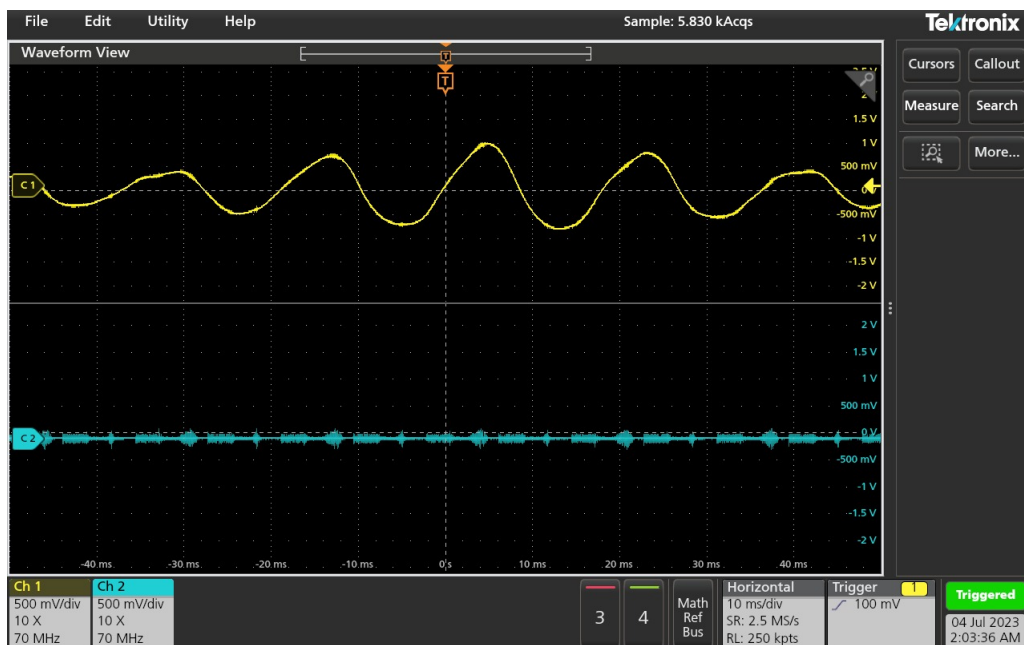
Figura 31 – Osciloscópio do experimento plotando a entrada do circuito (saída do piezoelétrico na cor amarela, enquanto que a saída atenuada é plotada na linha azul (Destaque 04 ampliado)
