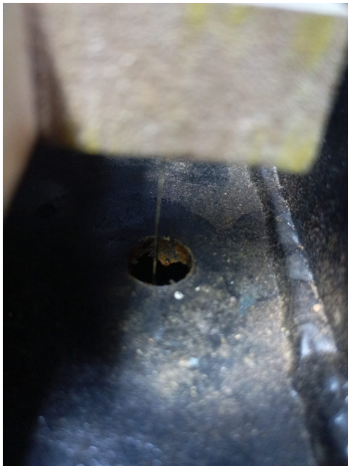
(a) Tubulação de passagem do fio de medição de massa
