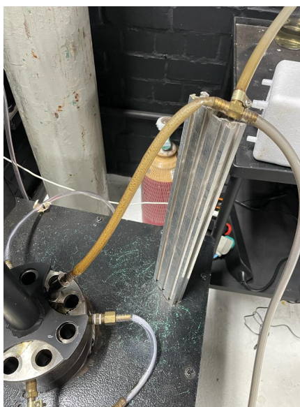
Figura 4.13: Alcatrão na tubulação. Fonte: De autoria própria.
