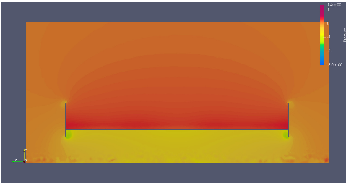
Figura I.22: Visualização de pressão do escoamento no plano yz do caso h130
