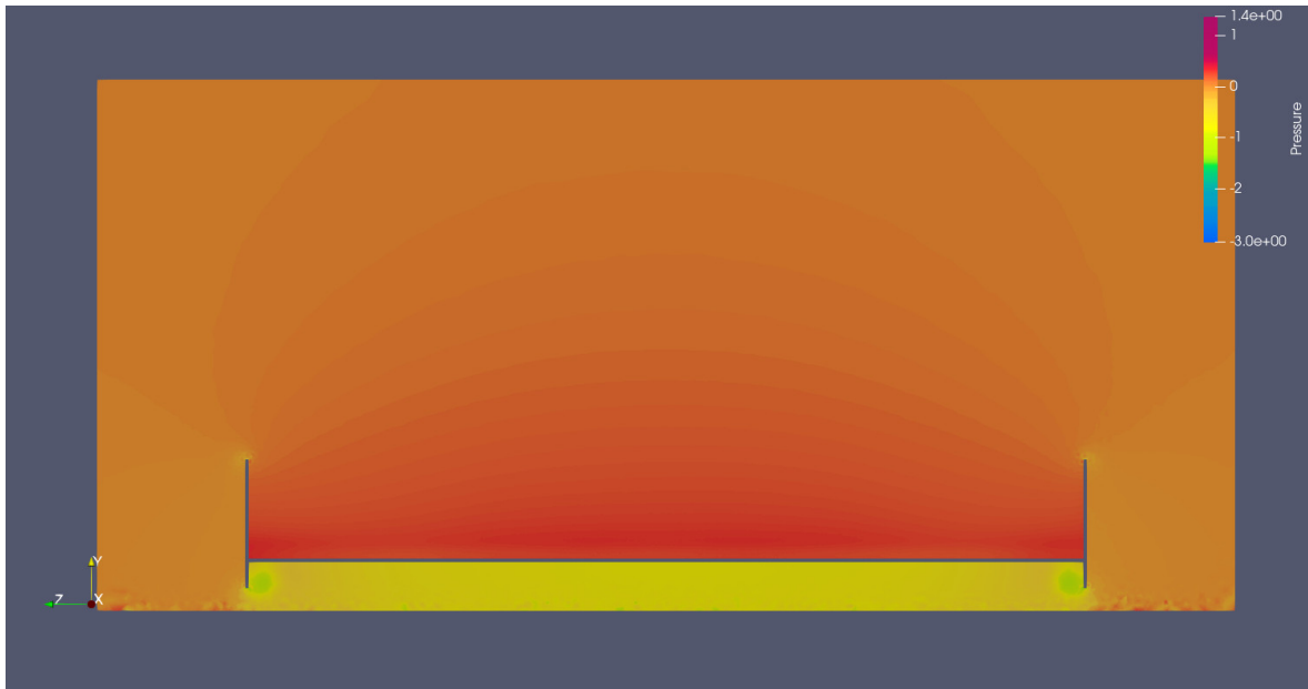
Figura I.6: Visualização de pressão do escoamento no plano yz do caso h30
