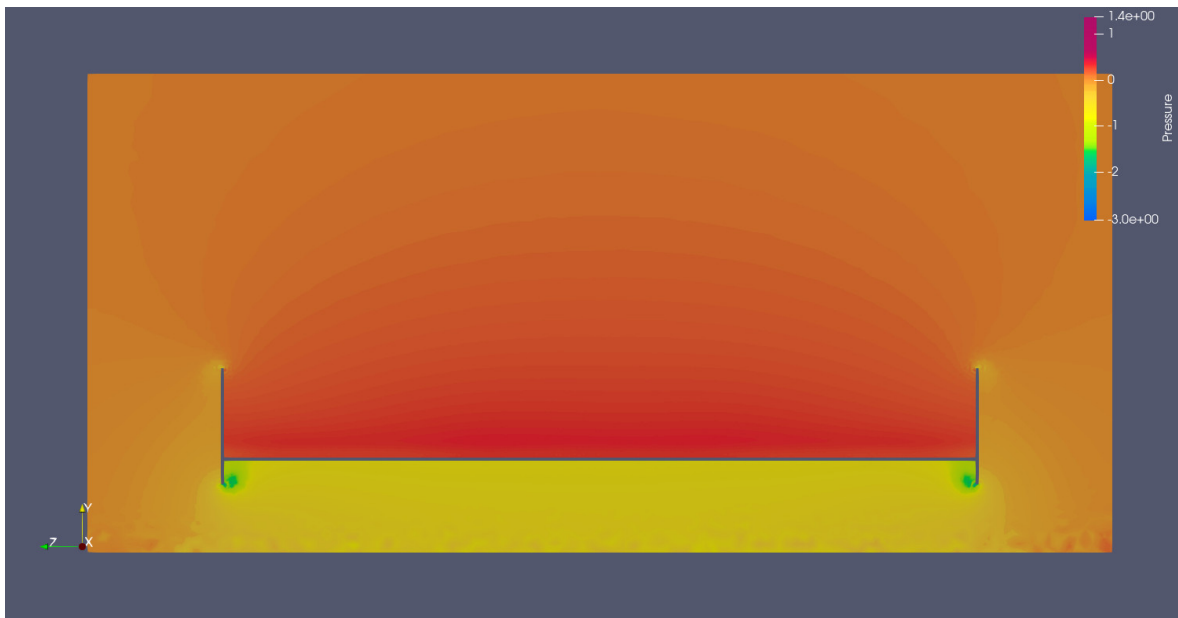
Figura I.19: Visualização de pressão do escoamento no plano yz do caso h100
