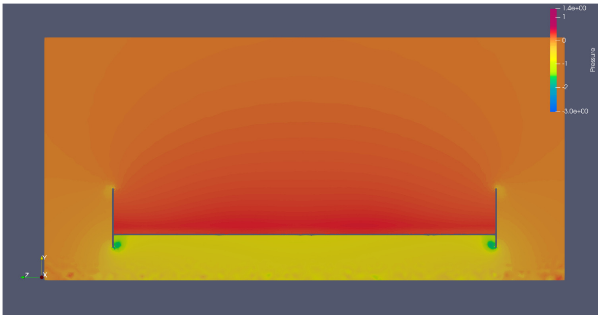
Figura I.18: Visualização de pressão do escoamento no plano yz do caso h95
