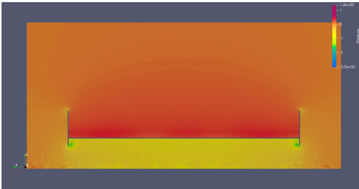
Figura I.20: Visualização de pressão do escoamento no plano yz do caso h110
