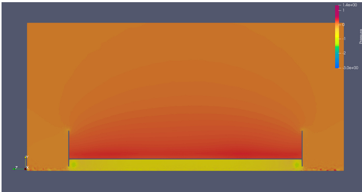
Figura I.2: Visualização de pressão do escoamento no plano yz do caso h20
