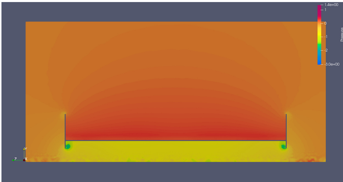
Figura I.14: Visualização de pressão do escoamento no plano yz do caso h70
