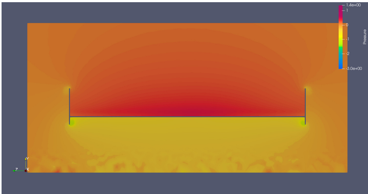
Figura I.24: Visualização de pressão do escoamento no plano yz do caso h225
