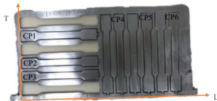
Figura 11 – Etapas do processo de remoção dos corpos de prova (SANTOS, 2022).
