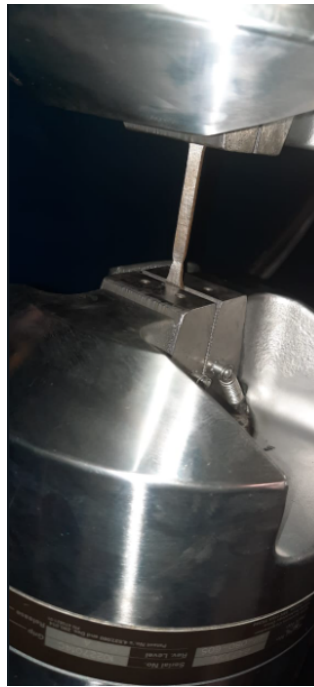
Figura 13 – Posicionamento do corpo de prova na MTS 810 Material System, Brasília - UnB, SG9.
