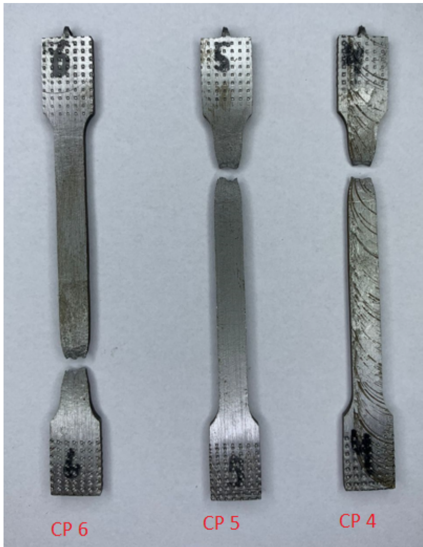
Figura 19 – Corpos de prova após a realização do ensaio.
