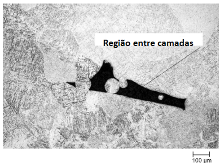
Figura 5 – Defeito devido a falta de fusão em componente fabricado a partir do material Ti-6Al-4V Khanzadeh et al. (2019)
