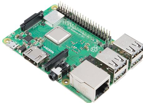
Figura 22 – Raspberry Pi 3 Model B+ [Fonte: (LTD, a)].
