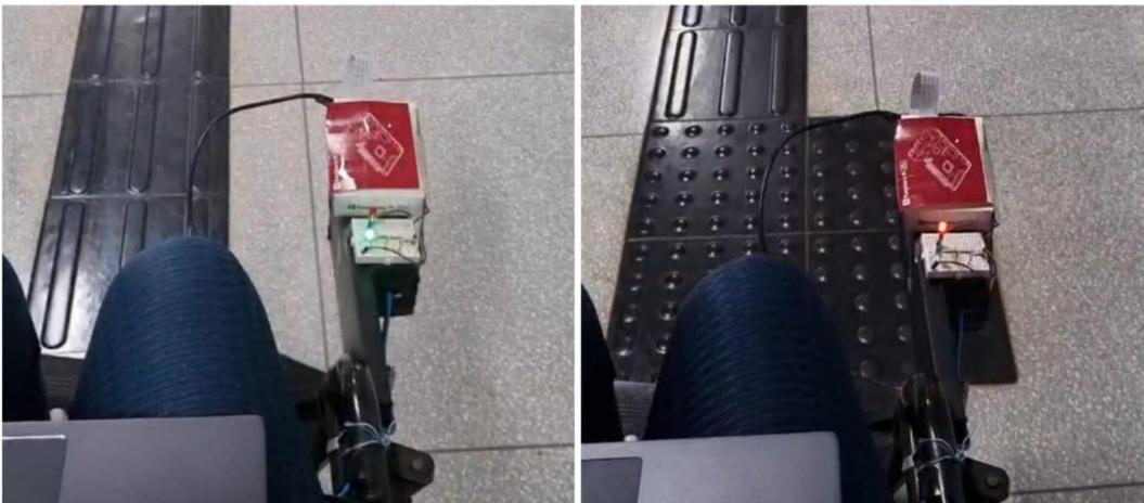
Figura 39 – Representação do tipos de piso por LEDs. À esquerda, tem-se a representação de um piso direcional, indicado pelo LED verde, enquanto à direita, tem-se a representação de um piso de alerta, identificado pelo LED vermelho.
