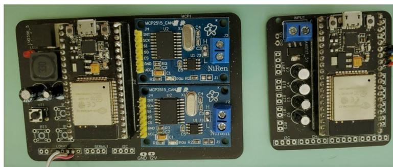
Figura 45 – Placas fabricadas: Sniffer(direita) e Volante(esquerda).
