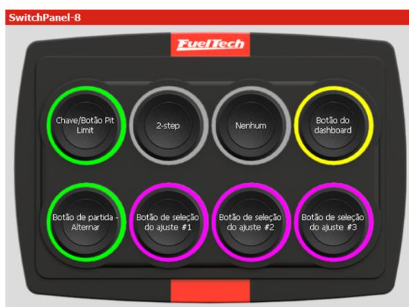
Figura 58 – Mapeamento dos botões do *Switch Panel*.
