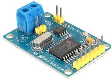
Figura 23 – Módulo de comunicação CAN MCP2515.
