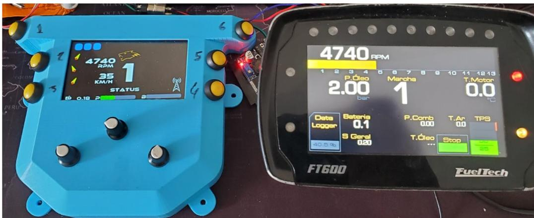
Figura 55 – Dados exibidos na FT600 e na central Volante.
