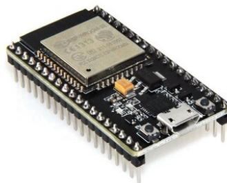
Figura 20 – Microcontrolador ESP32.
