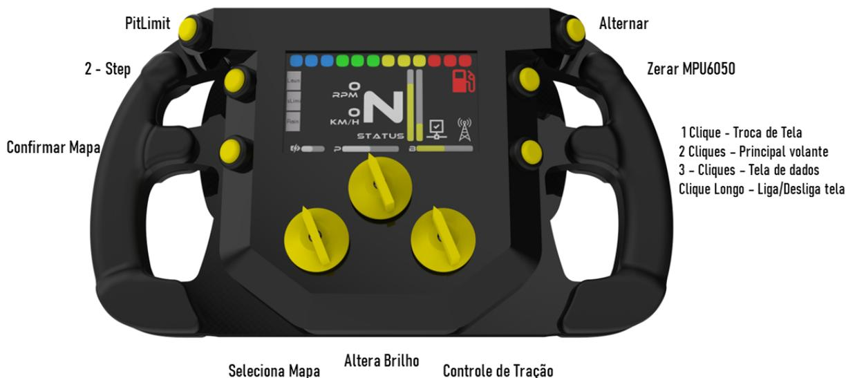
Figura 49 – Mapeamento dos botões no volante.
