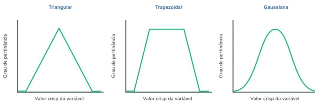
Figura 9 – Exemplos de funções de pertinência. O primeiro gráfico é um função de pertinência Triangular o segundo é Trapezoidal e o terceiro é uma função Gaussiana (TECH, 2020).
