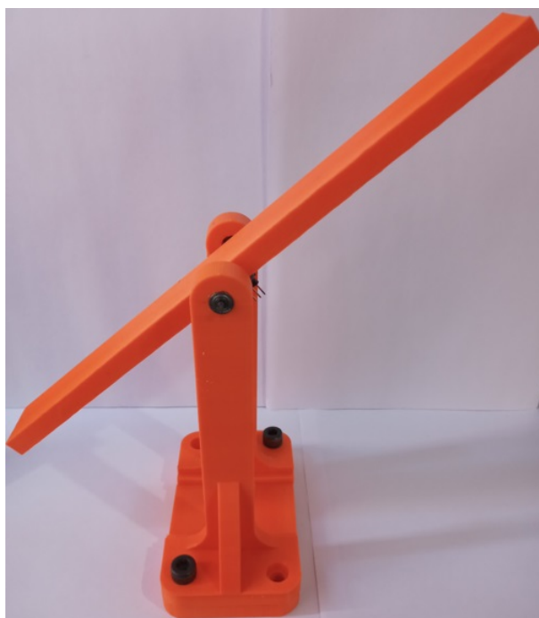
Figura 25 – Estrutura projetada para a bancada experimental do sistema de suspensão eletromagnética. As peças foram impressas com material termoplástico de PLA em impressora 3D.
