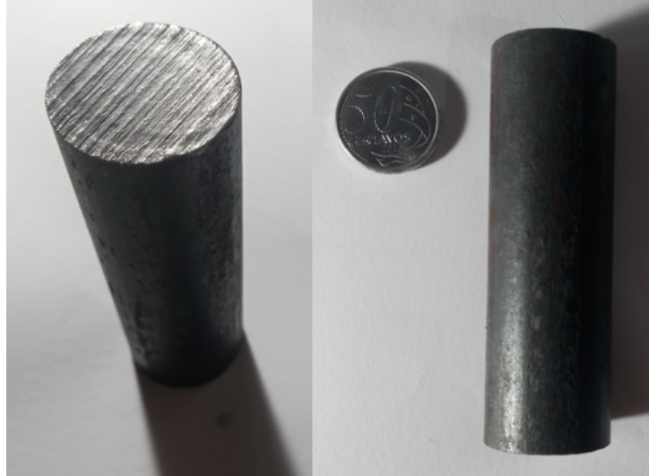
Figura 21 – Liga de aço 1045 utilizada como núcleo do eletroímã. Com dimensões de 25,5[mm] de diâmetro e 80[mm] de comprimento.
