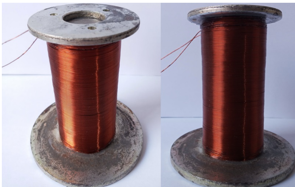
Figura 23 – Eletroímã projetado para a bancada do sistema de suspensão eletromagnética.
