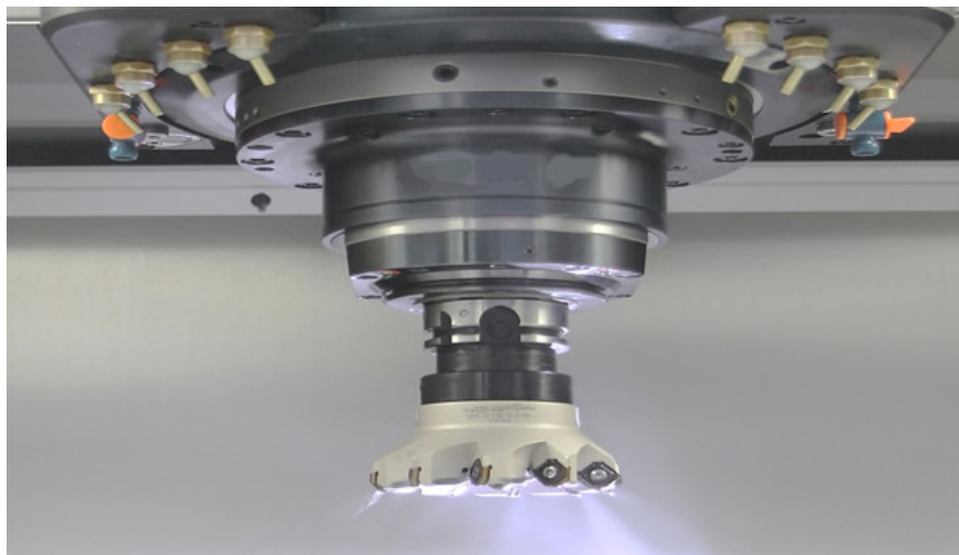
Figura 12 – Mínima Quantidade de Lubrificante (MQL) em fresamento (CADIUM, 2022).
