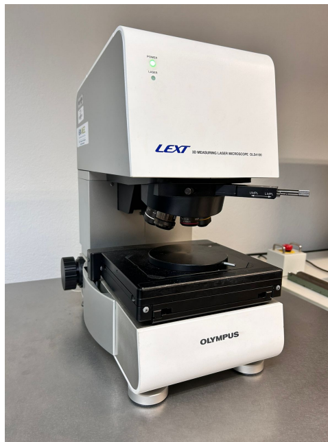
Figura 25 – Representação do equipamento utilizado - microscópio de medição LEXT OLS4100 (CM2P, 2022).
