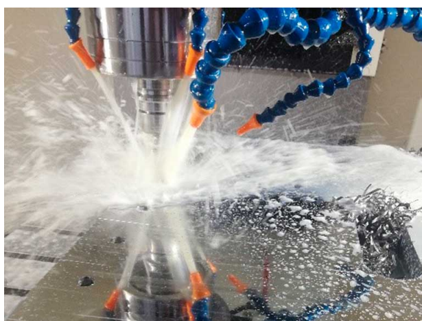
Figura 11 – Jorro a baixa pressão de fluido em fresamento (FLUVISERRA, 2022).
