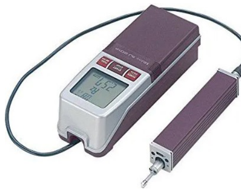
Figura 26 – Representação do equipamento utilizado - rugosímetro Mitutoyo SJ-201 (SEG, 2022).
