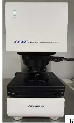
Figura 3.11 - a) Microscópio confocal Olympus LEXT OST 4100 b) vista frontal. (ENM/UnB). (Fonte-autoral)
