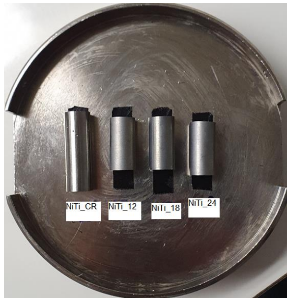
Figura 3.10- CP's preparados para análise no MEV – NiTi_CR, NiTi_TC12, NiTi_TC18 e NiTi_TC24 (ENM/UnB). (Fonte-autoral)
