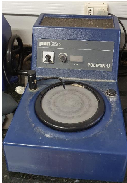
Figura 3.2 – Lixadeira manual Polipan-U-Pantec. (Fonte autoral).
