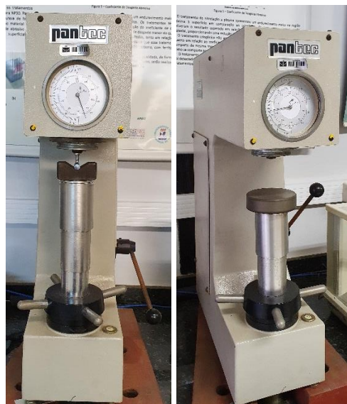
Figura 3.7 - Durômetro Pantec - Modelo Rasn-Rs Panambra (ENM/UnB). (Fonte autoral)
