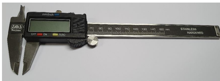
Figura 3.3 – Paquímetro Digital em Aço 150mm Mtx - Zaas Precision. (Fonte autoral).
