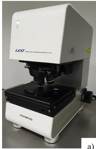
Figura 3.11 - a) Microscópio confocal Olympus LEXT OST 4100 b) vista frontal. (ENM/UnB). (Fonte-autoral)
