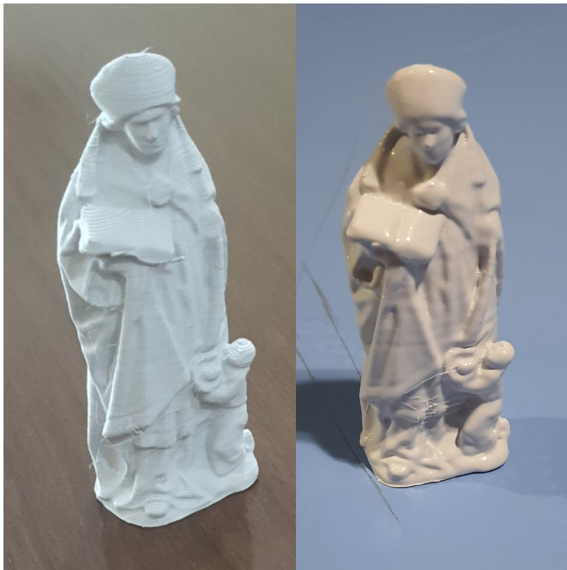
Figura 2.11: Peça impressa em ABS via FDM antes (esquerda) e após (direita) o banho em vapor de acetona
