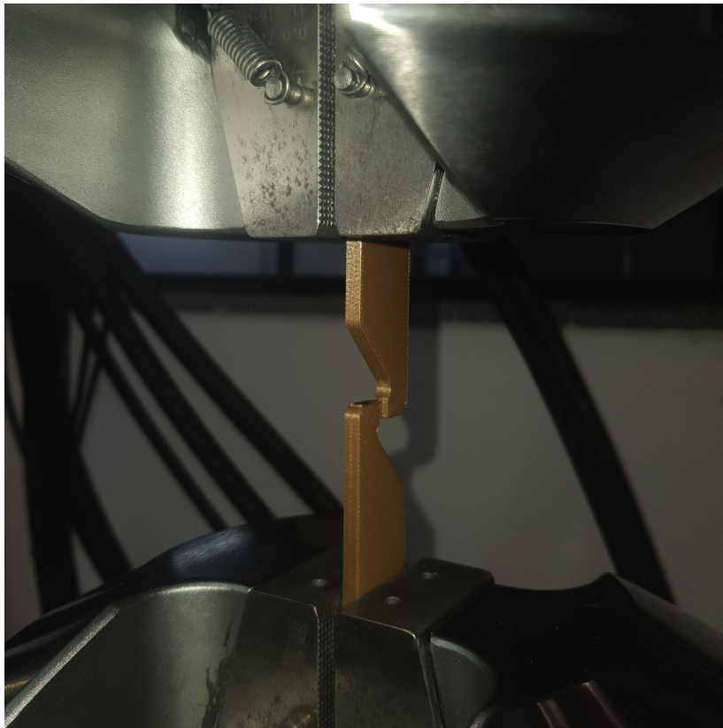
Figura 4.15: CP de cisalhamento posicionado na máquina MTS
