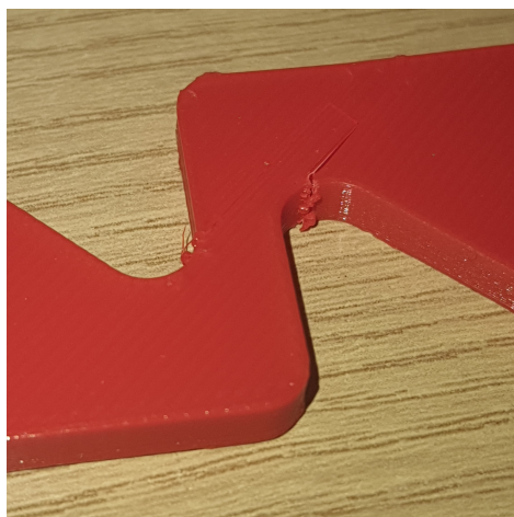
(b) Ampliação da região em que houve ruptura
