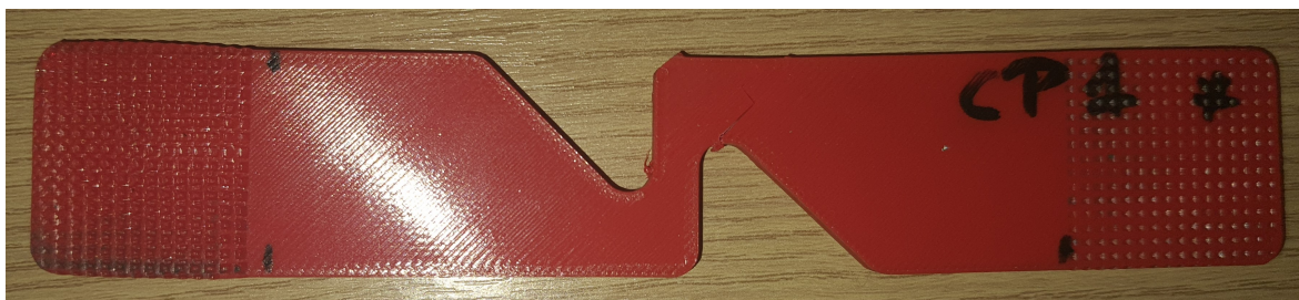
(a) CP de teste criado para avaliar a resposta mecânica e ajuste inicial de parâmetros
