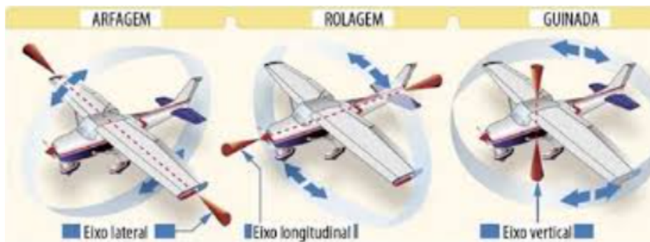
Figura 2.5 – Variações angulares em torno de cada eixo. Imagem tirada de (HANGAR33, s.d.)
