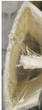
Figura 25 – Exemplo de peça com Stringing
