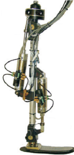
Figura 2.9 – Exemplo de prótese ativa atuada por pistões pneumáticos
