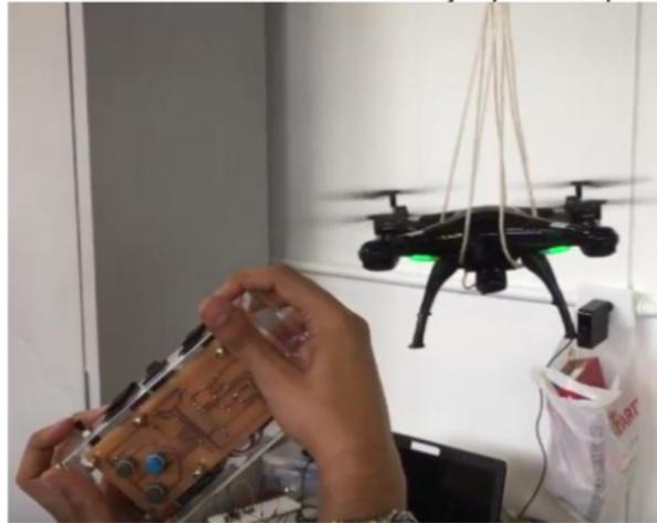
(a) plataforma inercial e o drone trabalho de [Pantoja e Garcia \(2017\)](#)
