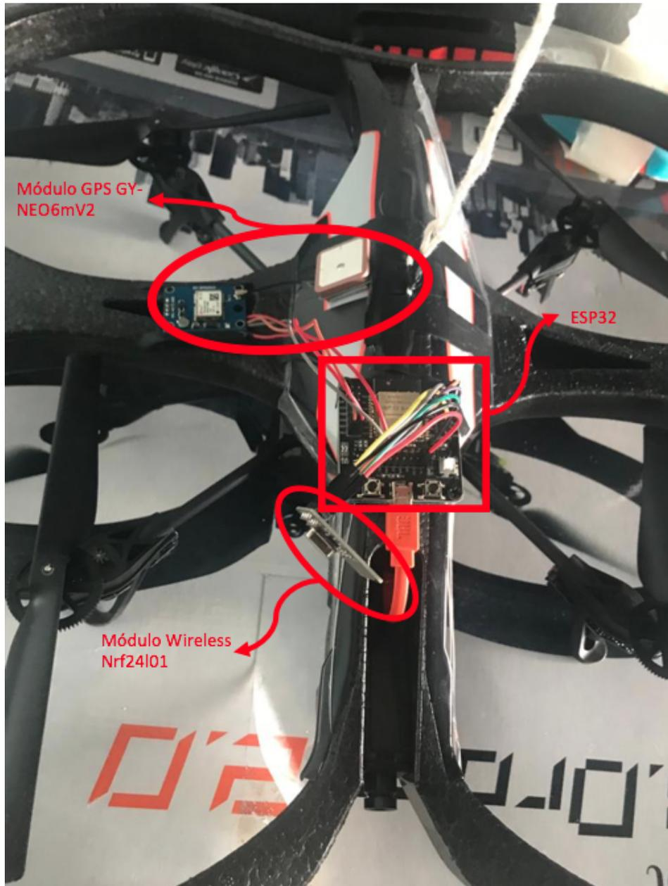
Figura 34 – Montagem do GPS no drone
