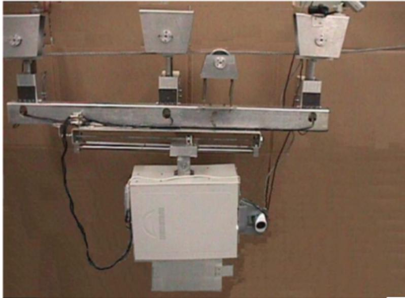
Figura 15 – Foto do robô de inspeção de linhas de transmissão.
