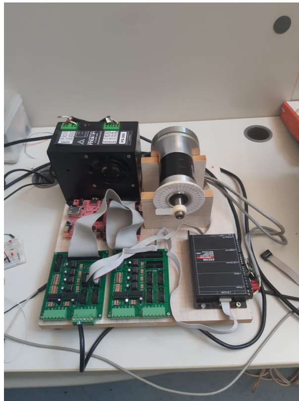
Figura 21 – Bancada de testes do motor e driver (Fonte: Próprio autor)
