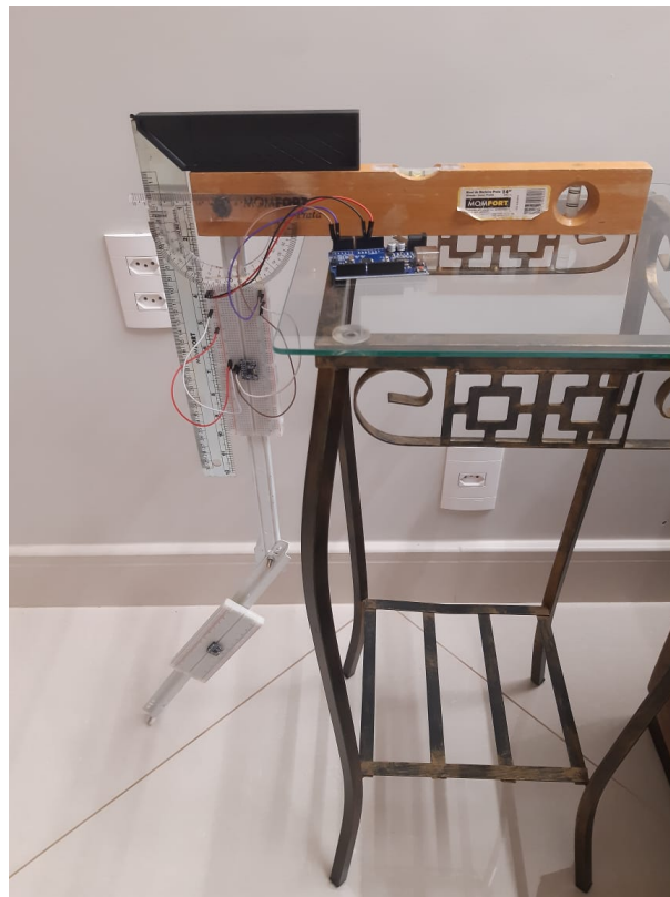
Figura 24 – Estrutura para testar os ângulos extraídos da MPU-6050 (Fonte: Próprio autor)
