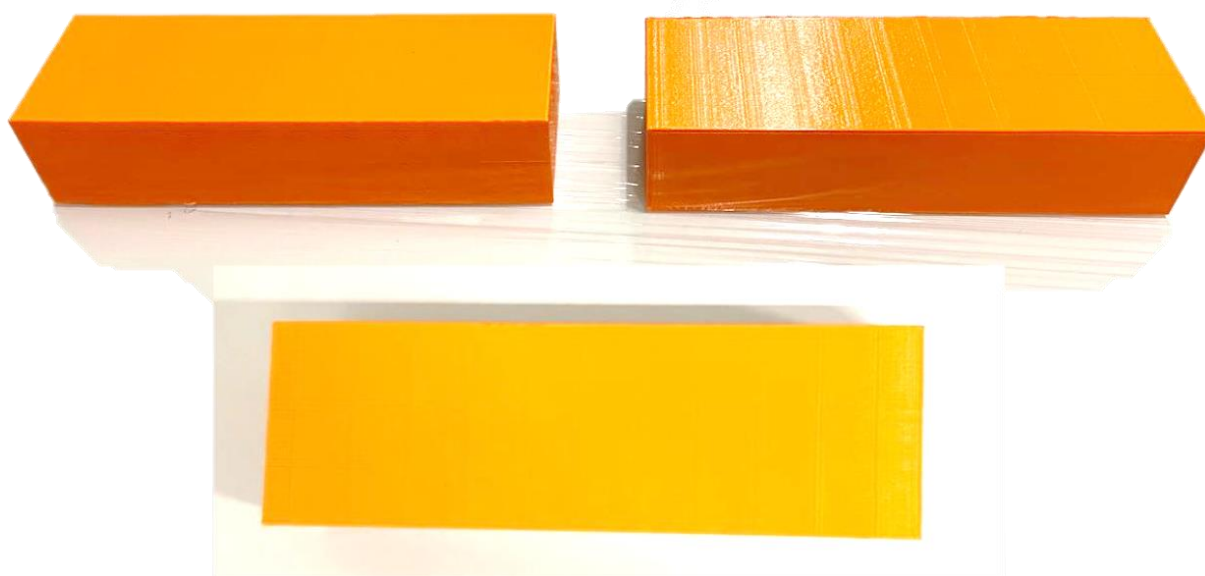
Figura 79 – Placas de PLA com núcleo triangular 10% impressa.
