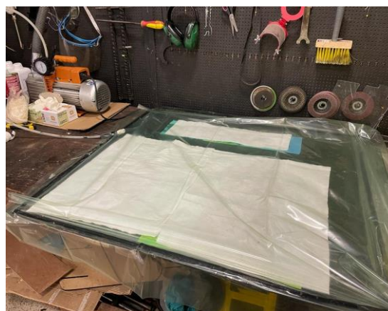
Figura 46 - Placa coberta com peel ply em verde e filme perfurado em azul a esquerda, Placa coberta com breather dentro da bolsa de vácuo.
