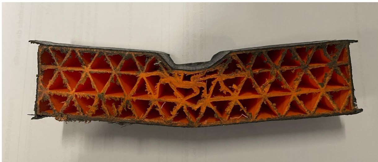
Figura 92 - Imagem interna após o ensaio da placa 2. Fonte: AUTOR.
