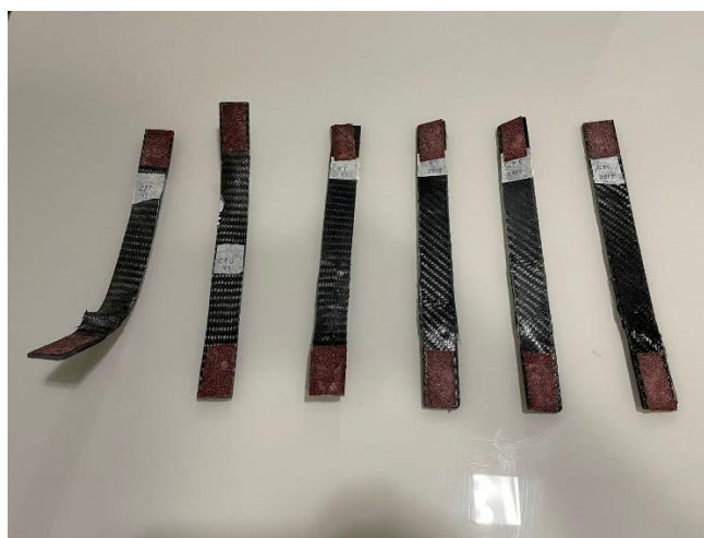
Figura 58 – CPs de carbono/epóxi pós ensaio de tração – Fonte: AUTOR.
