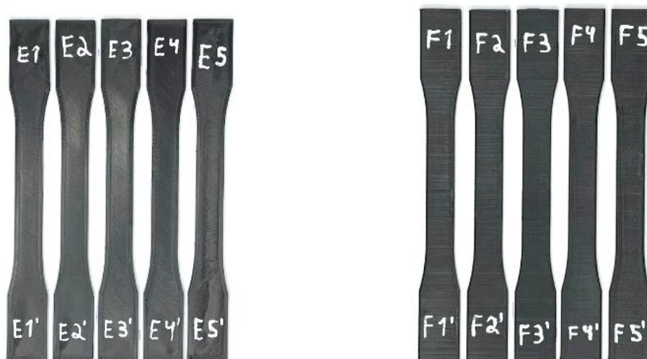
Figura 34 - Corpos de prova em ABS.
