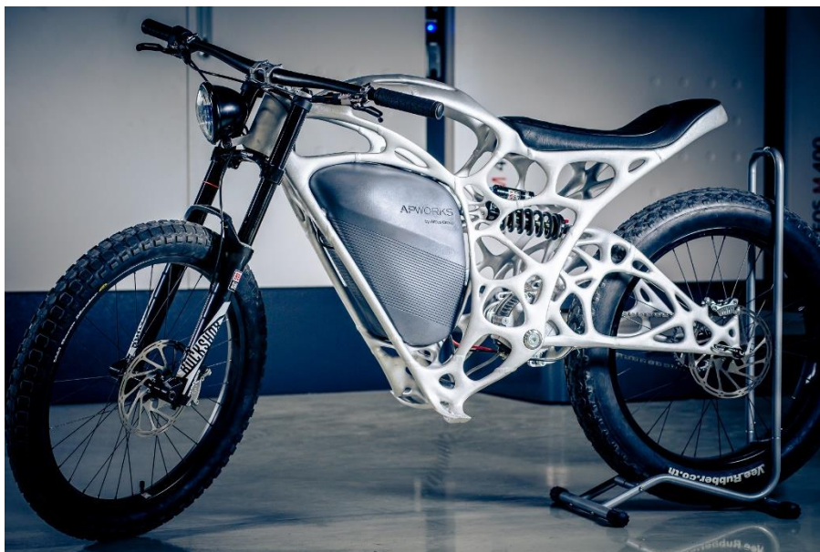
Figura 1-Chassi fabricado por MA-Fonte: FormLabs,2020.
