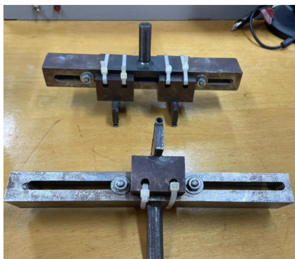
Figura 83 – Aparato do ensaio de flexão.
