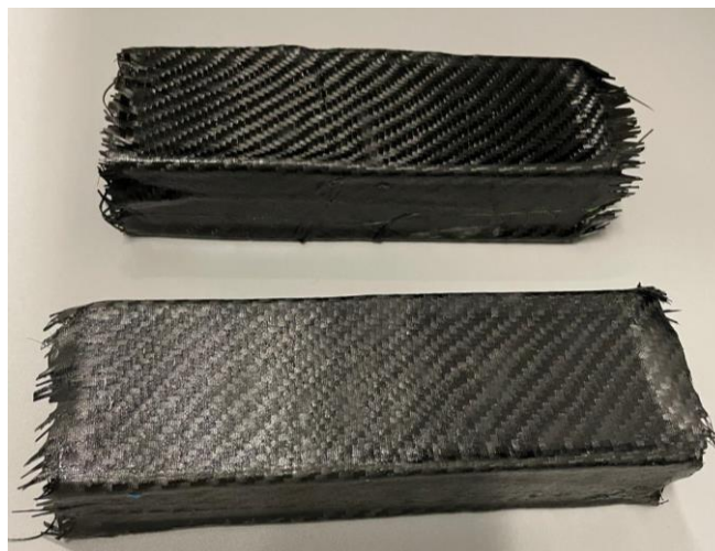
Figura 82 – Placas de núcleo em PLA involucradas em fibra de carbono/epóxi.
