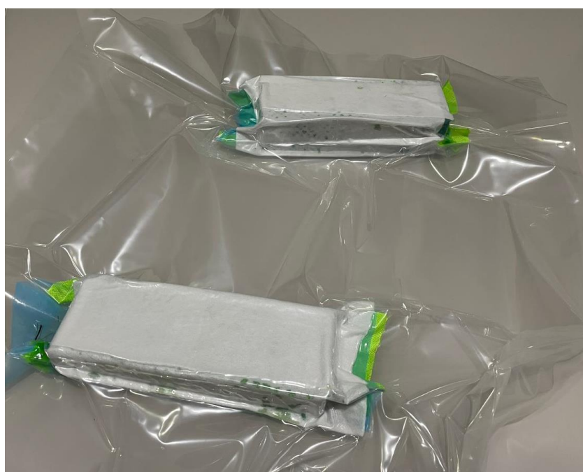
Figura 81 – Placas no saco de vácuo.
