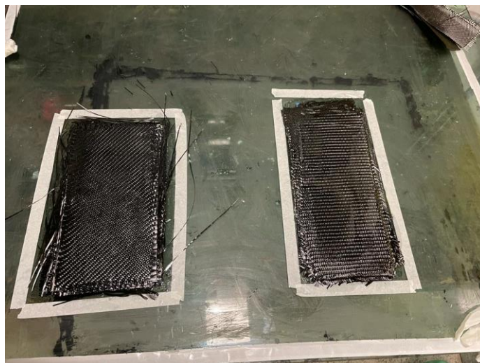
Figura 45 - Laminados pós aplicação de resina, 0/90 a esquerda e -45/45 a direita.
