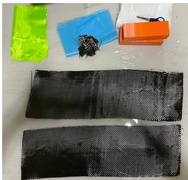
Figura 80 – Tecido de fibra cortado e sangradores para involucro da placa.
