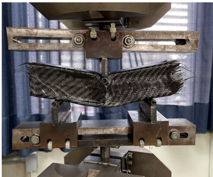
Figura 87 - Placa 1 ao final do ensaio.
