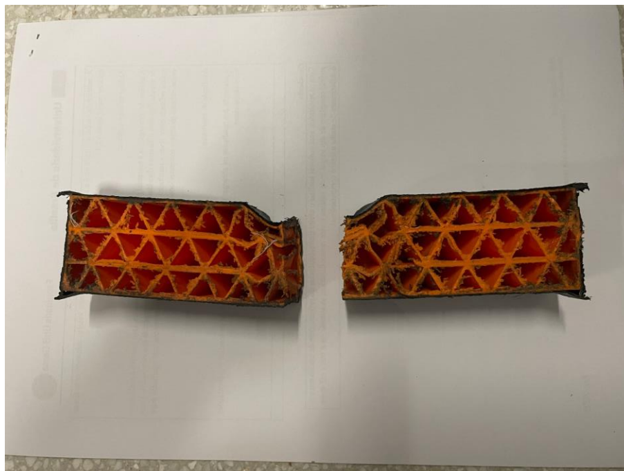
Figura 88 – Imagem interna após o ensaio da placa 1.
