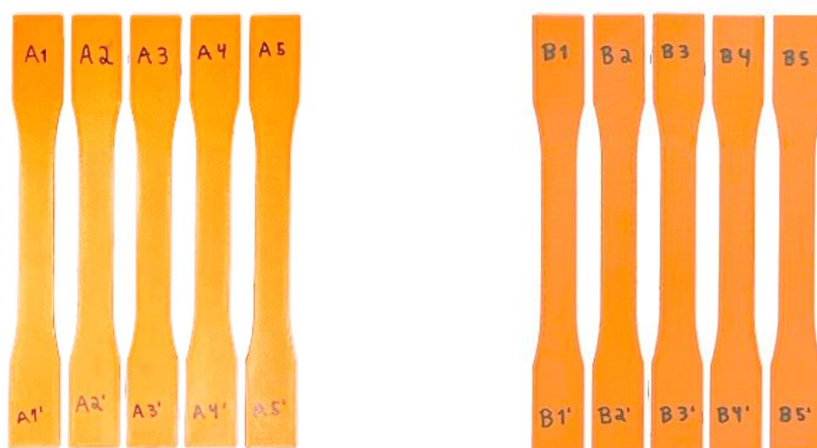
Figura 35 - Corpos de prova em PLA.
