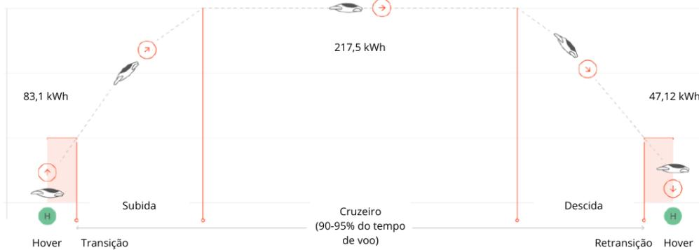
Figura 12 – Perfil operacional projetado com base no peso máximo de decolagem. Fonte: (NATHEN et al., 2021).
