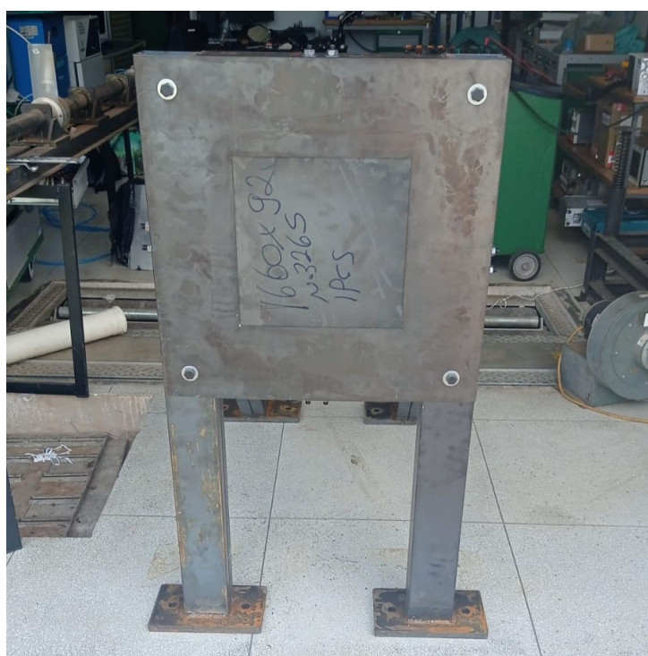
Figura 53 – Anteparo balístico com chapa de aço ASTM A36 , mostrando sua face frontal.
