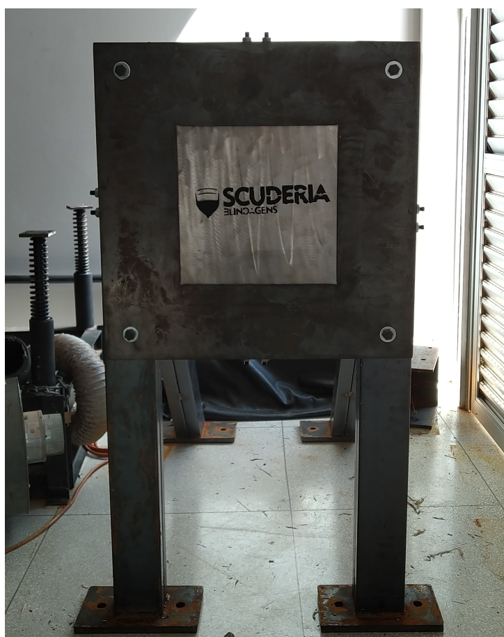
Figura 55 – Anteparo balístico com chapa de aço inoxidável 304L.
