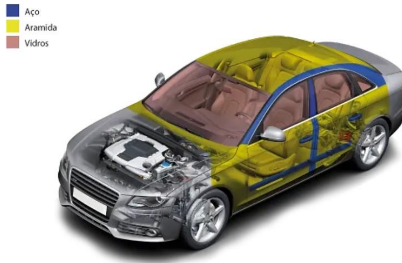
Figura 20 – Locais de aplicação da blindagem em aço (BLOOMBERG, 2020).
