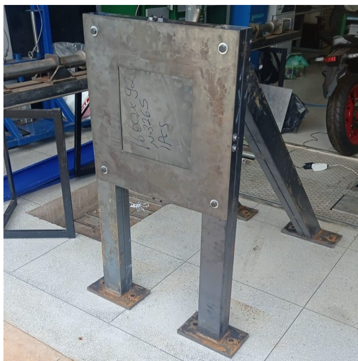
Figura 54 – Anteparo balístico com chapa de aço ASTM A36
