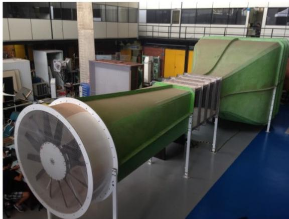
Figura 9 – Túnel de vento do Laboratório de Energia e Ambiente da Universidade de Brasília (MENDES, 2020).
