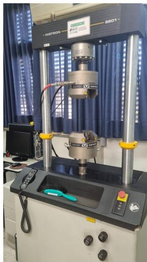
Figura 58 – Máquina de ensaio de flexão Universal Instron 8801 – Fonte: autor
