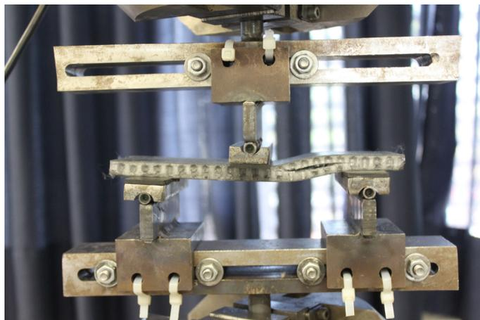
Figura 48 – Ensaio de flexão 3 pontos de painel sanduíche – Adaptado de: (CARVALHO, 2019)
