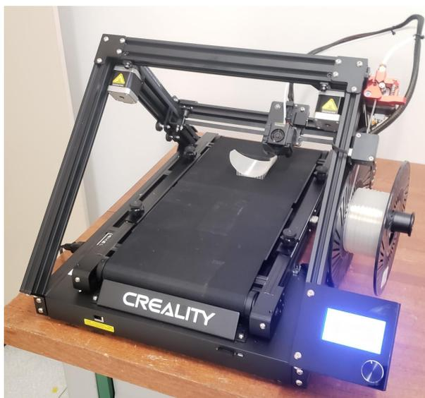
Figura 42 – Impressora CR-30 da Creality realizando a impressão de um protótipo de protetor – Fonte: autor
