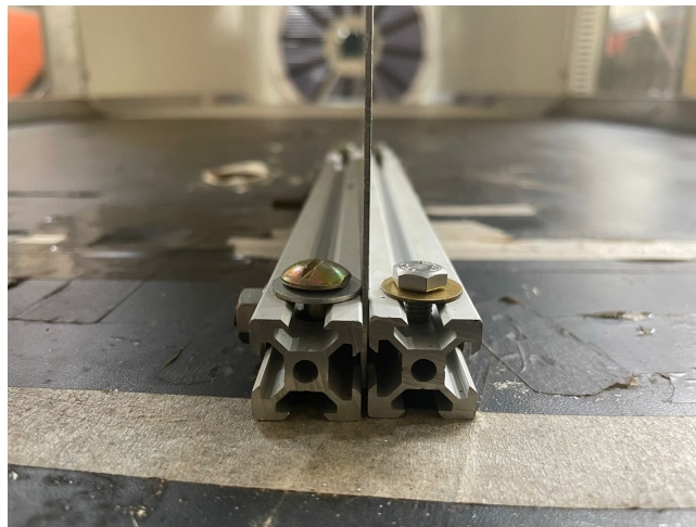
Figura 20 – Fixação dos perfis na parede do túnel de vento.
