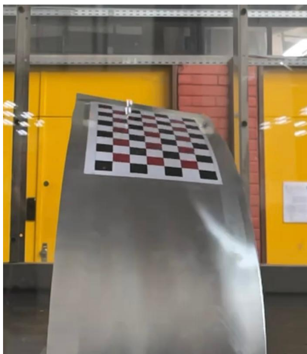
Figura 23 – Placa flexionada após o escoamento atingir velocidades mais altas.
