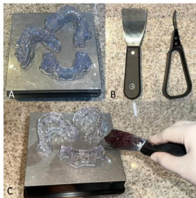
Figura 29: A) AAMs na plataforma de construção; B) Espátulas utilizadas para remover os aparelhos; C) Retirada dos aparelhos da plataforma.
