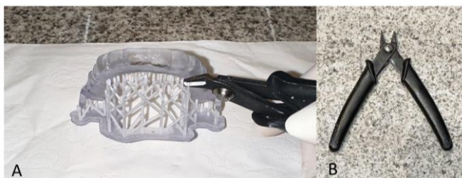
Figura 31: A) Hastes do aparelho sendo cortadas; B) Alicates utilizados para a remoção das hastes de suporte.
