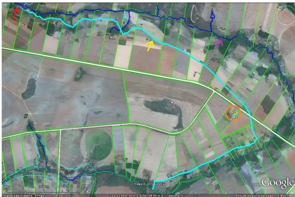
FIGURA 1 – Croqui geral do projeto. A seta vermelha indica a localização da barragem; a seta amarela o curso do canal; a seta roxa o Ribeirão jardim; e o círculo laranja a sede do Núcleo Rural Tabatinga.
