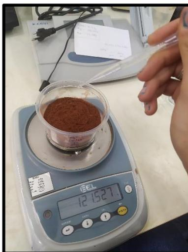
**Figura 8.** Aplicação de água para manter os teores de água iniciais de cada solo.
