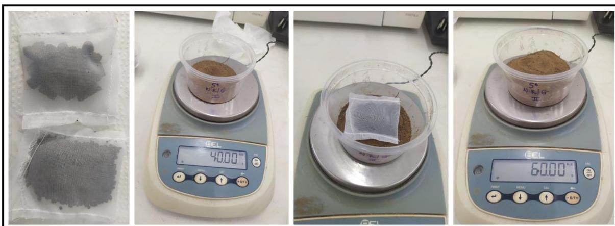
**Figura 7.** Sequência mostrando os fertilizantes em sachês, pesagem das amostras de solo e montagem das unidades de incubação.
