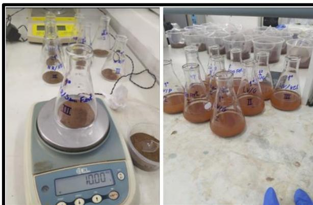
Figura 11. Pesagem de amostras e solo com a solução extratora Mehlich 1.
