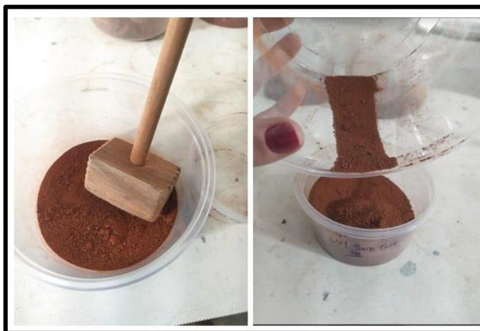
**Figura 10.** Solo seco ao ar e destorroado.
