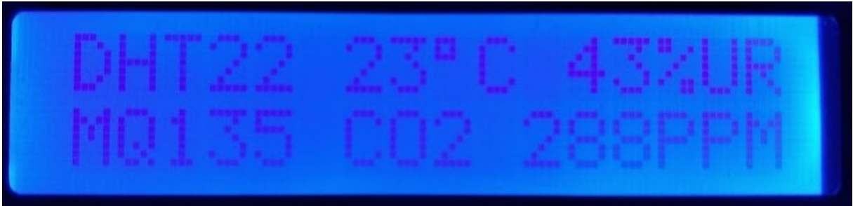
Figura 8: exemplo de funcionamento do mostrador de LCD com medidas instantâneas.
