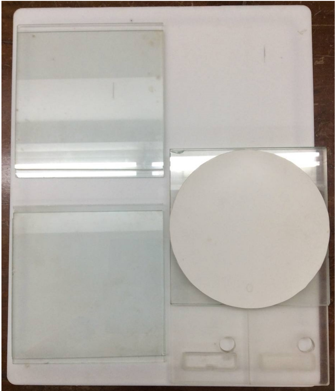
Figura 18 – Suportes de vidro e acrílico usados para elevar a altura da proveta.
